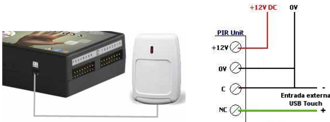
Conexión sensor con salida a transistor NPN
